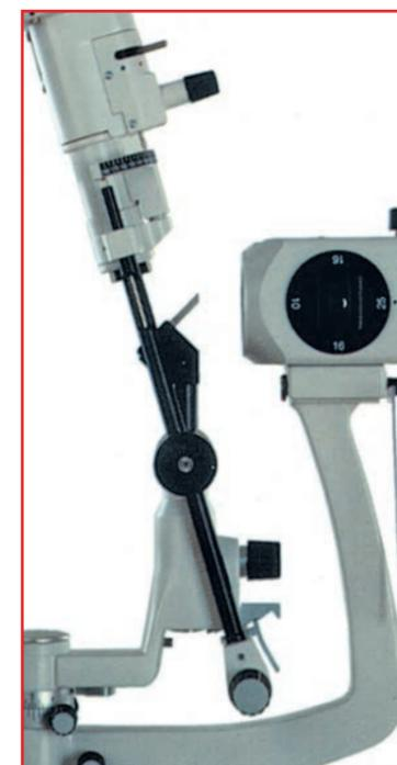
Особенностью системы освещения щелевой лампы CSO SL 9900 является наличие наклона осветителя, когда падающий свет может отклоняться от вертикали до угла 20° с шагом в 5°.
